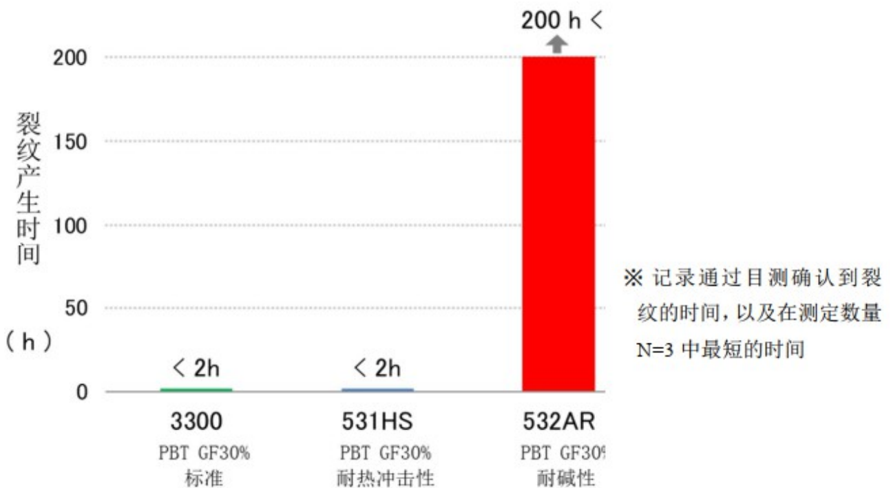
图 2-2 在碱性环境下应力开裂发生的时间
